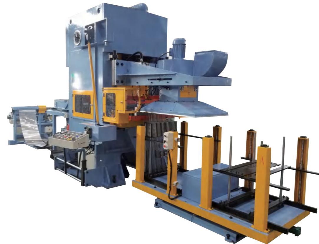
闭式翅片生产线由开卷机，过油箱，翅片冲床，真空吸盘和集料装置组成。适用于大批量规模化生产，如7mm模具24-72列，9.52模具18-48列，12.7模具12-24列，15.88模具12-24列。
